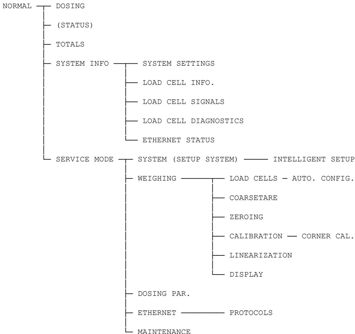
Under normal brug er det kun nødvendigt at benytte **NORMAL** og **DOSING** skærbilledet. De øvrige skærbilleder benyttes under installation og kalibrering.
