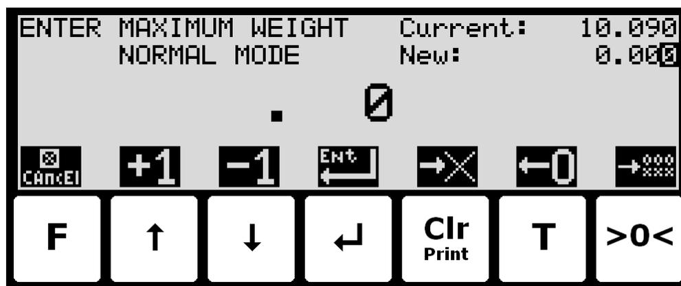
Den aktuelle parameter der skal ændres vises i den øverste venstre del af displayet. Den aktuelle parameter værdi og den aktuelt indtastede værdi vises i den øverste højre del af displayet. Den aktuelt indtastede værdi vises også med stor font i midten af displayet.
