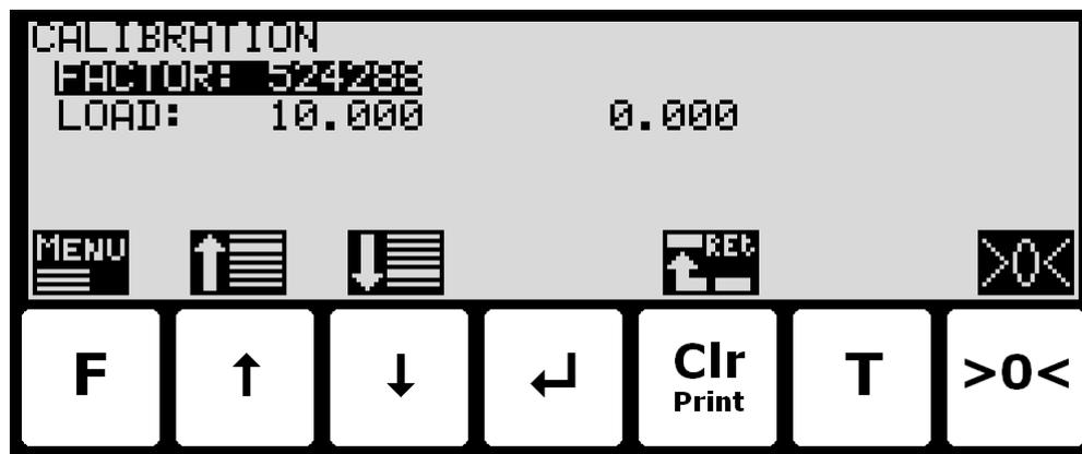
I dette skærbillede vises kalibrerings parametre som kalibrerings faktor, kalibrerings last (til venstre) og aktuel brutto vægt (til højre), og det er muligt at ændre disse. Dette gør det muligt at kalibrere systemet. Fra **CALIBRATE** menuen er det muligt at vælge **CORNER CALIBRATION** skærbilledet for hjørne kalibrering af systemet. En cursor (inverteret tekst) indikerer den aktuelt valgte parameter.
