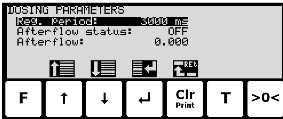
I dette skærmbillede vises doserings parametre såsom registreringstid og efterløbskorrektion, og det er muligt at ændre disse.
