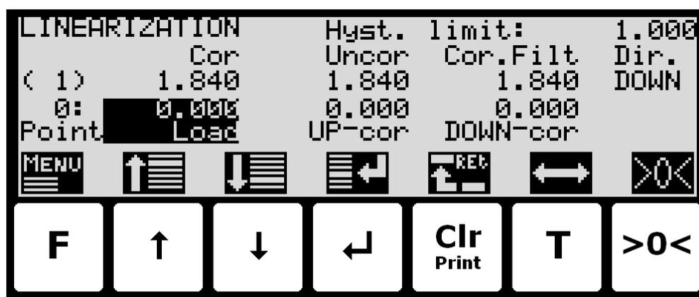
I dette skærbillede vises lineariserings parametre, og det er muligt at ændre disse for eksempelvis at kunne kompensere for hysteresi i systemet. I den nederste halvdel af skærbilledet over tastatur ikonerne vises det valgte lineariseringspunkts nummer, den indtastede last for dette punkt og op/ned korrektionerne (adderes/subtraheres) for dette punkt. Umiddelbart over dette i den øverste halvdel af skærbilledet vises det aktuelt benyttede interval,
