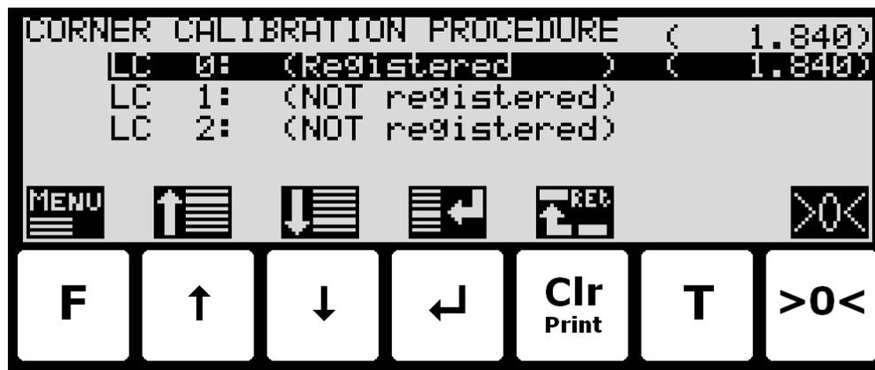
I dette skærbillede vises en linje for hver vejecelle indikerende "NOT registered". Når signalet resulterende fra en given belastning placeret over en vejecelle er registreret, ændres indikationen til "Registered" efterfulgt af den registrerede belastning for denne vejecelle/hjørne. Den aktuelle bruttovægt vises i det øverste højre hjørne.
